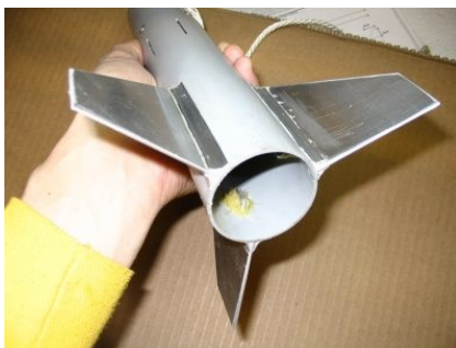
Visualização detalhada das aletas e método de fixação Clique para ampliar a imagem
